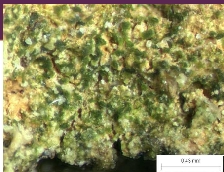
Photo 1 : Colonisation d'algues à la surface du calcaire à débris de Dom-le-Mesnil (âge : Bajocien Moyen) qui est un calcaire roux macroporeux. Observations à la loupe binoculaire (photo : S. Eyssautier)
